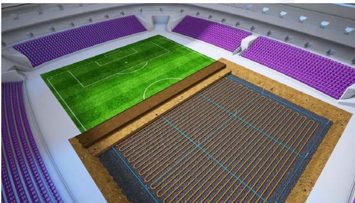
Figure 23 : Système d'aspiration et de ventilation classique à conduites
