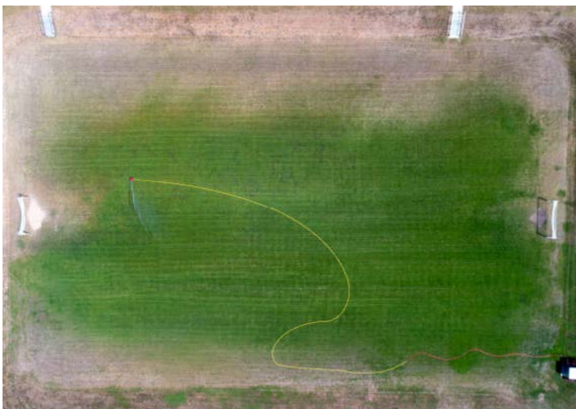
Figure 21 : Exemple d'une couverture d'irrigation insuffisante
