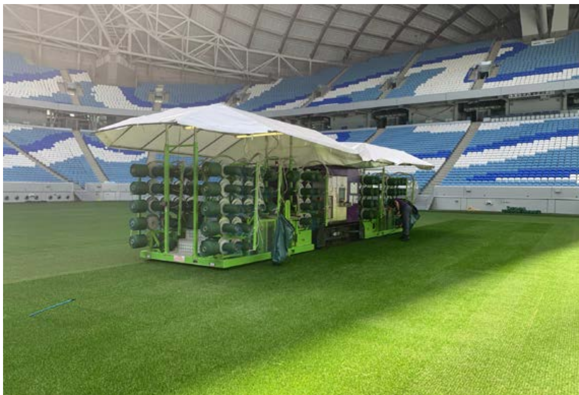
Figure 7 : Piqueuse servant à installer les systèmes de renforcement piqués hybrides
